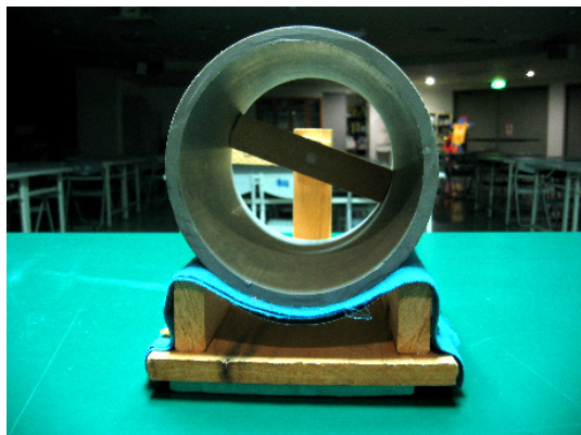
圖 3、兩支木條製成可容納 PVC 管的槽狀構造，在此槽狀構造上裝設有半圓弧型鋁片，鋁片上方鋪一層羊毛尼龍混紡的布料
