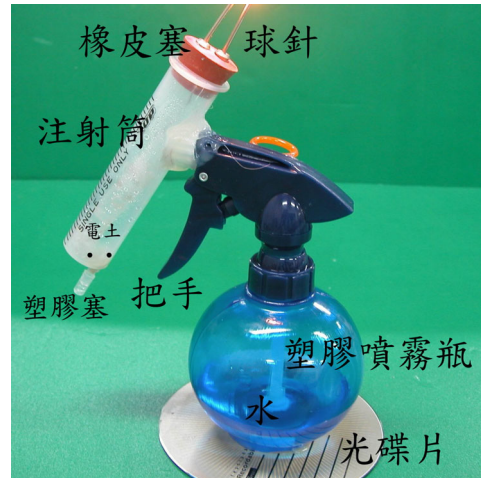
圖三 自製簡易電石照明器示意圖
