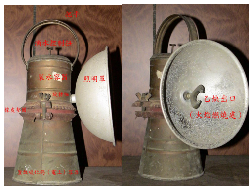
圖一 電石照明器之構造示意圖
