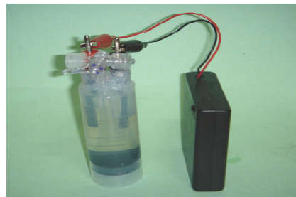
照片二 改良式燃料電池裝置電解作用之側面圖
