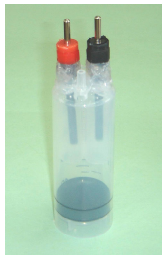
圖四 電極固定後之裝置側面圖
