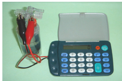
照片三 改良式燃料電池裝置放電作用的俯視圖
