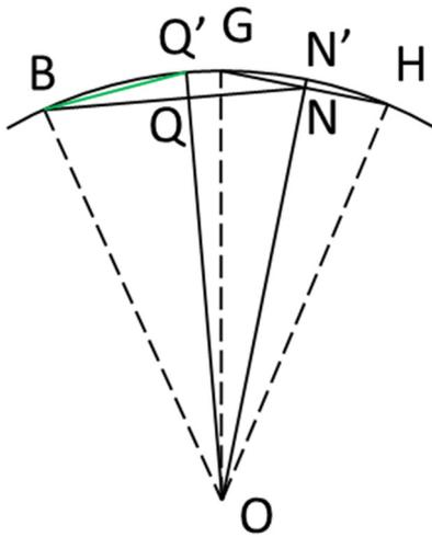
圖 15、繪圖求綠色鋼棒長度
