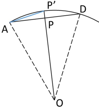
圖 11、繪圖求藍色鋼棒長度
