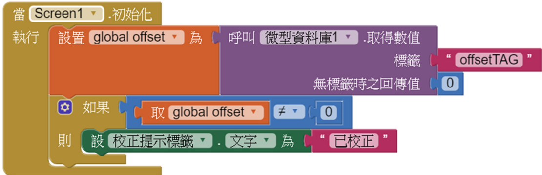
圖 29、加入條件「offset 不等於 0」，若條件成立的話則更改校正提示標籤的文字
