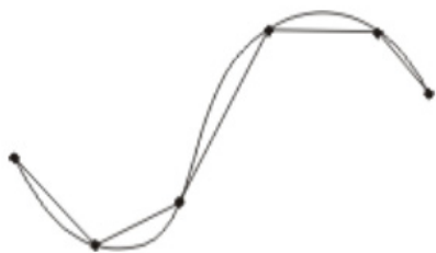
圖 3、在曲線上取有限多個點，連成折線，計算折線的長度
