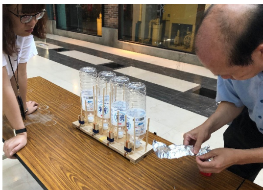
圖四、作者正將鋁箔撕成長條狀作為可破壞性開關（左）。紅色的膠帶將鋁箔黏在寶特瓶上，鋁箔兩端分別接通電源線與裸銅絲。
