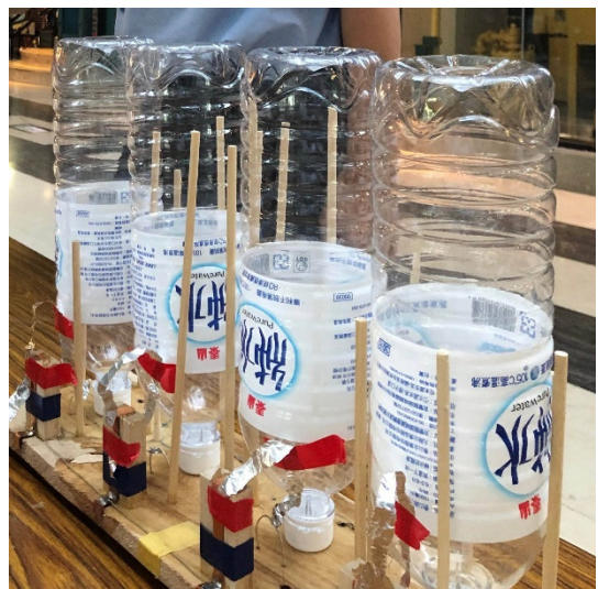
圖四、作者正將鋁箔撕成長條狀作為可破壞性開關（左）。紅色的膠帶將鋁箔黏在寶特瓶上，鋁箔兩端分別接通電源線與裸銅絲。
