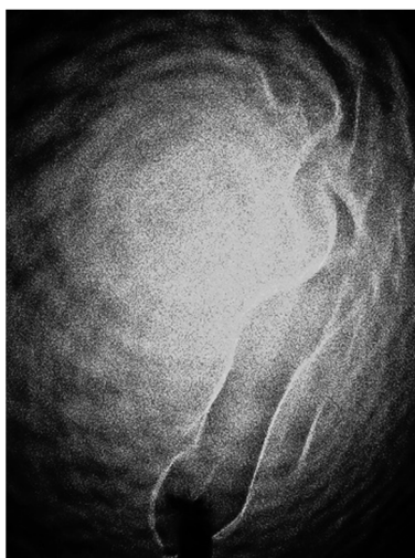
圖五(b)、根據相同的原理，因為雷射光亮度很高，可以先將平行的雷射光經小放大鏡聚焦，形成點光源，再射到白色幕上。在幕和雷射光聚焦的點之間，置一燭火，一樣可以看到熱氣流。但效果仍不及用拋物面鏡的辦法。
