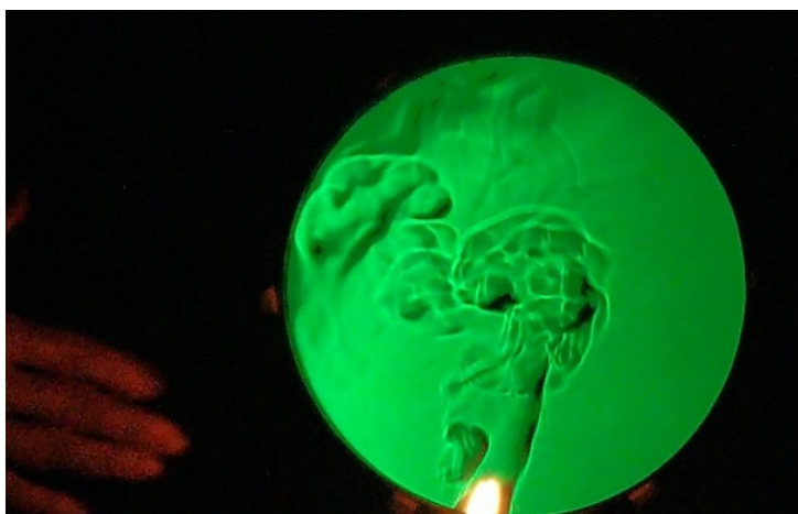
圖五(a)、燭火上方的熱氣流清晰可見。
