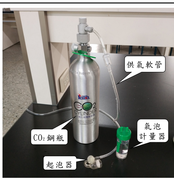
圖二、CO 2 鋼瓶(3 公斤)，含氣泡計量器、起泡器、供氣軟管
