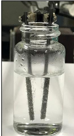
設定直流電壓 10 伏特，固定電壓持續 1 小時，記錄電流值。
