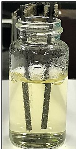
1 小時結束後關閉直流電源，取出電極，碳點溶液以 5000 轉/分 離心 10 分鐘，去除底部雜質避光保存。
