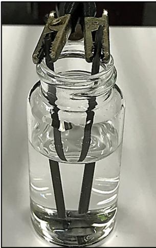
將高溫處理過的筆芯對折，分別夾在直流電源供應器的正負極，放入裝有 15 毫升電解液的樣品瓶，調整距離約 1 公分避免兩極相互接觸以及接觸瓶身、瓶底。
