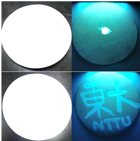
圖九、上圖螢光奈米碳點固體於可見光和紫外光燈下的照片；下圖為使用隱形墨水寫的字於可見光和紫外光燈下的照片
