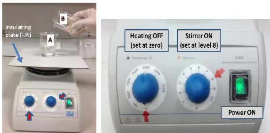
圖 1、碘鐘實驗動力學研究所用之設備。
