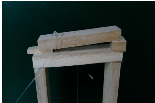
圖三：繃緊釣魚線的廉價方法。木棒上多穿幾孔，釣魚線穿繞其中，便於打結。讀者也可以自行設計繃緊釣魚線的方法。
