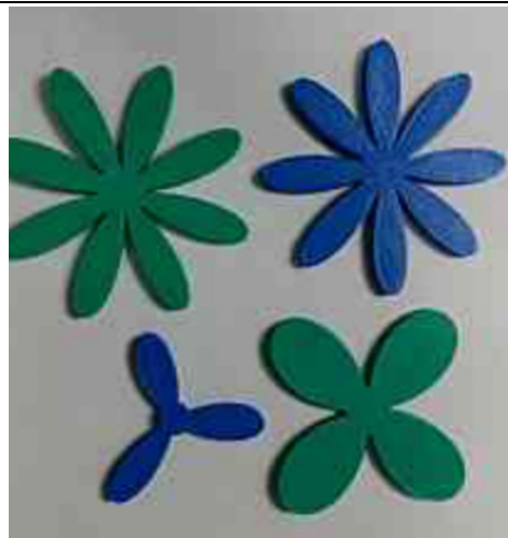
3 瓣、4 瓣及 5 瓣玫瑰線成品，為避免圖形斷裂，圖形中央加入圓形。
