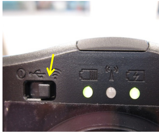
圖 2. 電子目鏡本體的 USB 模式 (左圖) 與 Wi-Fi 模式 (右圖) 切換
