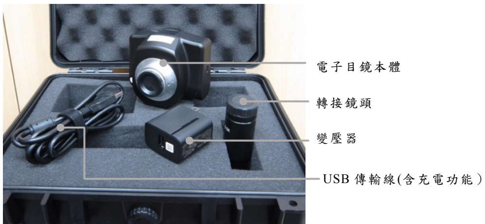
圖 1、本研究使用電子目鏡系統元件示意圖
