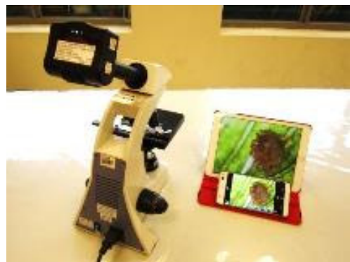
圖 4. 電子目鏡與光學顯微鏡、平板電腦組裝完成照
