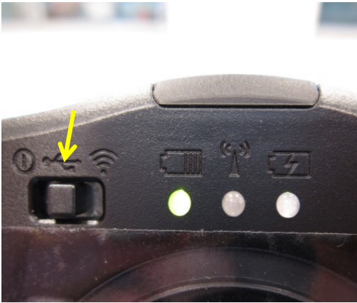
圖 2. 電子目鏡本體的 USB 模式 (左圖) 與 Wi-Fi 模式 (右圖) 切換
