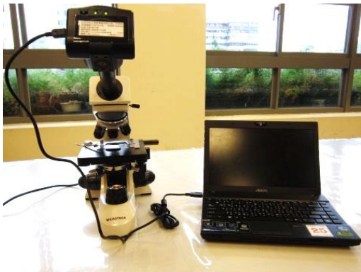
圖 3. 使用 USB 有線傳輸方式傳輸影像示意圖
