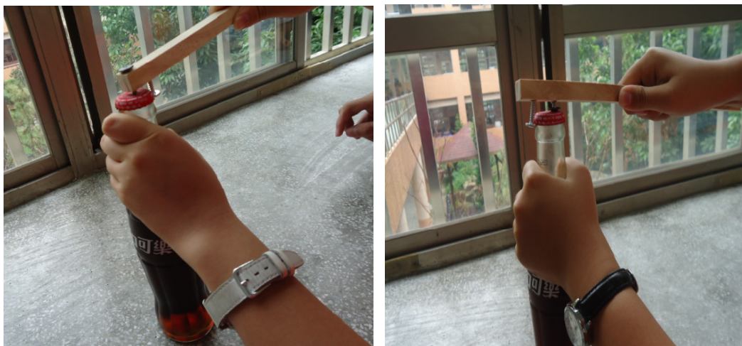
圖六、學生設計的開瓶器類型。左為抗力點在中間的類型，右為支點在中間的類型。
