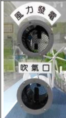
3-3 上下吹風口步驟 專為各不同身高及不同年段學生，設置上下兩吹氣送風口，及大小觸發開關導風片。
