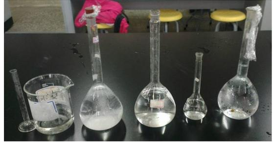
圖二 將磷標準溶液稀釋成 5ppm、0.5ppm、0.05ppm 和 0.005ppm 後，各取 50mL 置於 100mL 燒杯中，分別加入 8mL 混合試劑
