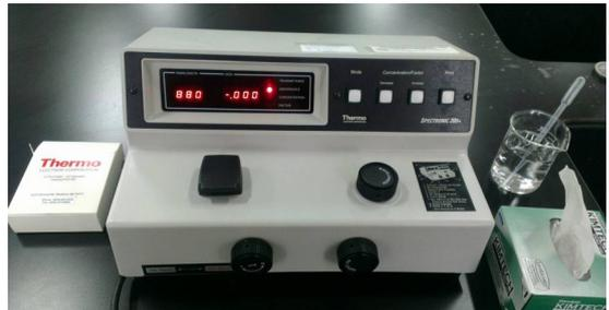
圖三 在 10~30 分鐘內，以分光光度計於波長 880nm 處讀取吸光度
