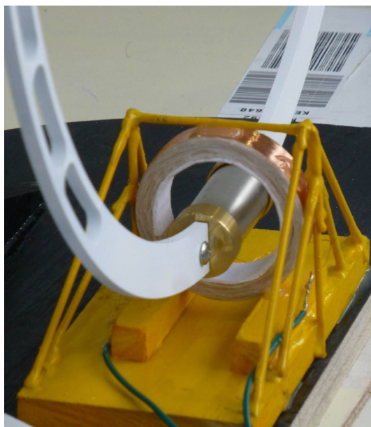
圖五：感應線圈的內徑明顯比磁鐵直徑大
