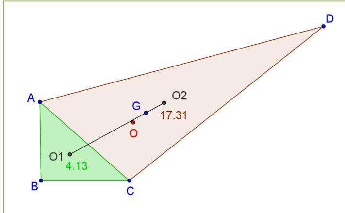
上圖四邊形 ABCD 的重心 G，是由  $\triangle ABC$  的重心  $O_1$  與  $\triangle ACD$  的重心  $O_2$ ，按照兩三角形的面積(代表重量)以槓桿原理計算得到，換言之如果有一根針尖頂住重心 G 它是可以平衡的，G 就是重心，但平均坐標點 O 卻與 G 有一點點的差距。
