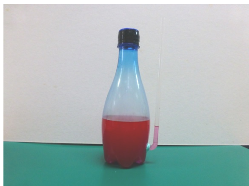
圖 6 用濕巾沾冰水輕輕靠近塑膠瓶上方，水管水位降低
