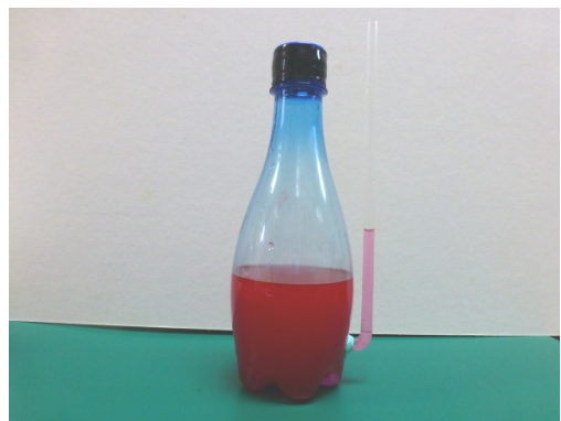
圖 5 手輕輕靠近塑膠瓶上方，水管水位升高
