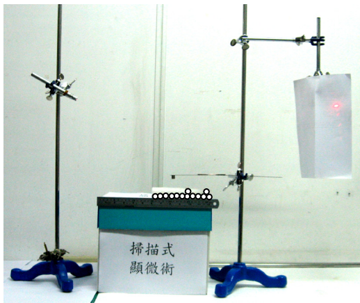
圖 7(a) 掃描式顯微系統演示實驗側視圖
