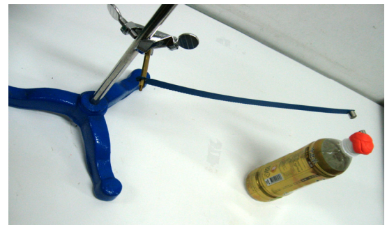
圖 2(b) 受外力作用時，懸臂彎曲。待測磁鐵可以黏土固定於盛水寶特瓶等重物上。
