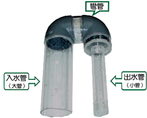
圖 13、大小管徑虹吸管的設計
