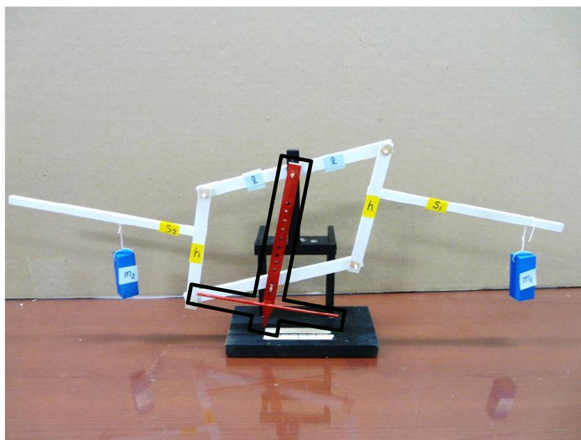
圖 4、十字架即能繞轉軸擺動（圖中粗線條框住，向左歪斜的十字形部分，為文中所謂的十字架）。
