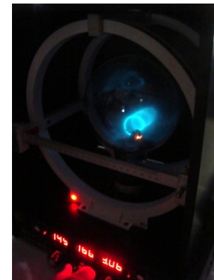
圖八、開啟亥姆霍茲電壓，產生磁場，當磁場方向與電子束方向不為 90 度，且電子束強度減弱時，磁場強度相對較大，電子束仍呈現螺旋型運動，但偏折程度增加，螺旋半徑變小
