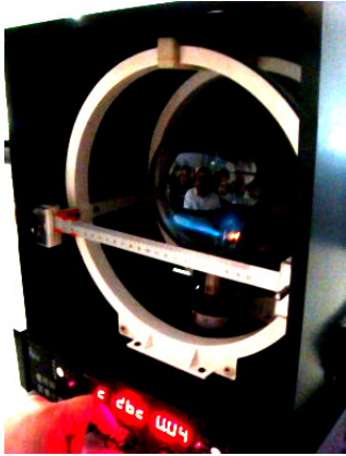
圖三、未開啟偏轉板電壓，電子束正常未偏折
