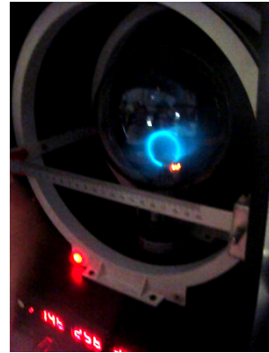
圖六、增強亥姆霍茲電壓，產生的磁場變大，當磁場方向與電子束方向垂直，電子束因偏折程度增加，圓周運動的半徑縮小
