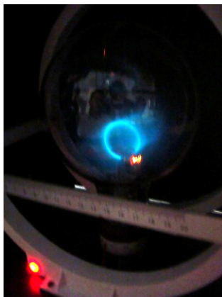
圖五、開啟亥姆霍茲電壓，產生磁場，當磁場方向與電子束方向垂直，電子束成圓周運動
