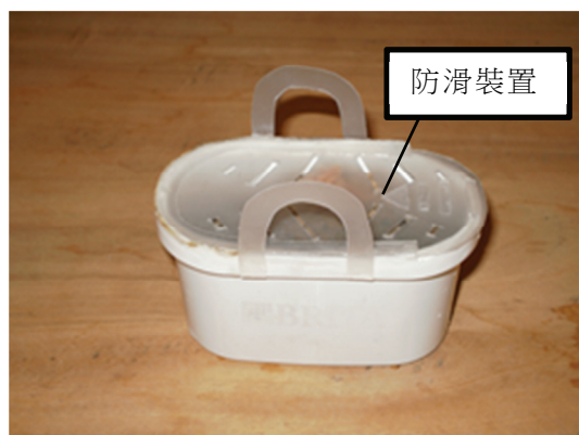
圖 5-2、我們自行研發改良的濾心(蓋子緊閉)
