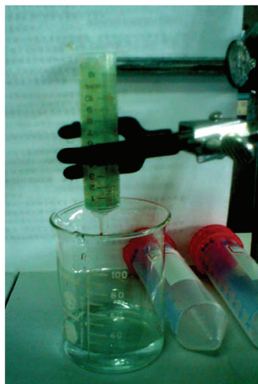
附錄三：利用拋棄式塑膠針筒裝填膠球進行過濾(近照)。針筒內為純藻酸鈣膠球，燒杯內則為過濾後的濾液。
