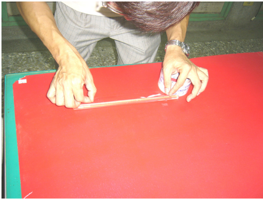
圖 6e、撕下一層膠帶（20~30cm 長），貼在壓克力棒，並消除電荷。
