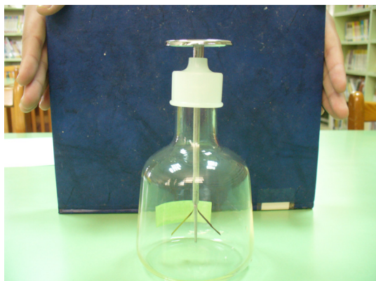
圖 5a、利用感應接地起電法使金箔帶正電。
