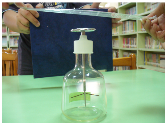
圖 5b、膠帶帶正（+）性電，箔片的張開的角度會增加。
