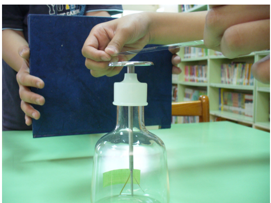
圖 5c、膠帶帶負（-）性電，箔片的張開的角度會減少。
