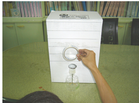
圖 3a、以不帶電的物體測靜電感應距離，測出大約為 6cm。
