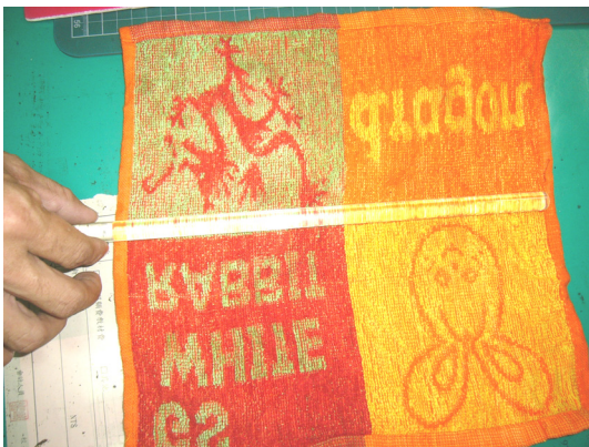
圖 6f、撕下另一層膠帶（20~30cm 長），貼在壓克力棒，並消除電荷。
