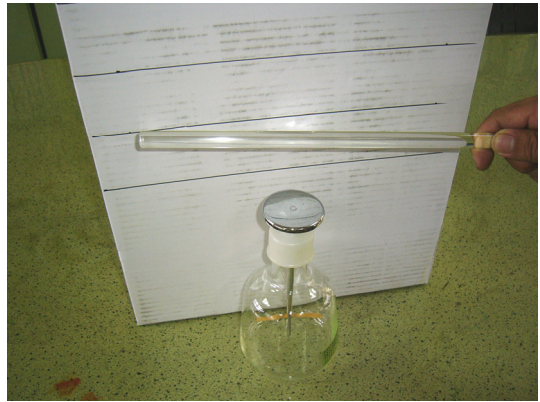
圖 6h、將第二層連壓克力，使金箔開，帶負電。
