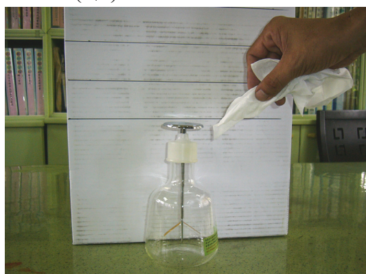
圖 6b、以衛生紙快速碰金屬盤，調整兩金箔的夾角約 90 度。
