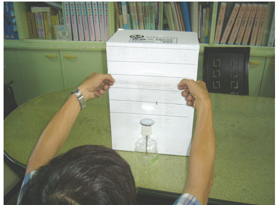
圖 6g、撕下第一層，使金箔閉合，帶正電。
