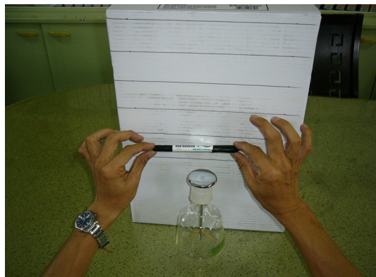
圖 6c、以不帶電物質測感應距離並劃線。
