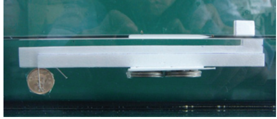
圖(23b) 為「過平」之俯仰姿態。從水槽底部放開水下滑翔機模型時，不會前進也不會後退，將會呈現以此狀態而垂直浮出的情況
