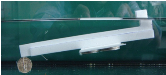
圖(23c) 為「艏部過沉，艉部過仰」之俯仰姿態。從水槽底部放開水下滑翔機模型時，雖仍會浮出水面，但是會朝艉部後退
