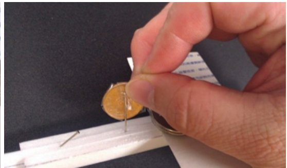
圖(22b) 將「俯仰角度調整器」垂直插入原黏貼 1 元硬幣之中心處
