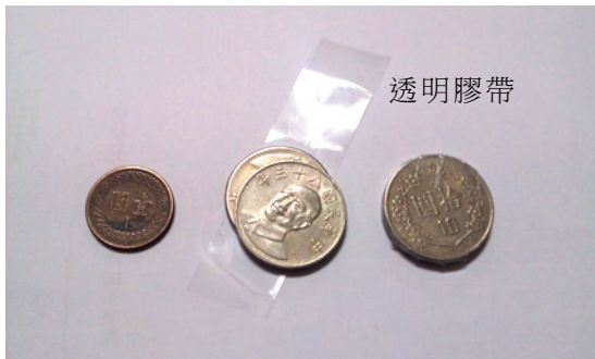
圖(8a) 將10元硬幣4枚，依2枚一疊之方式利用透明膠帶固定疊合。
