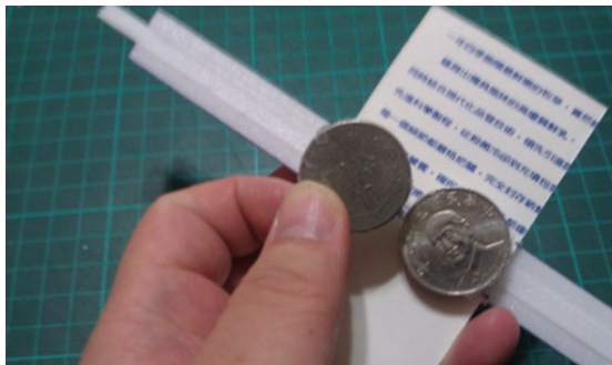
圖(8d) 將二疊10元硬幣及1元硬幣1枚依圖(19)之建議黏貼至翼板及機體下方對應處。
