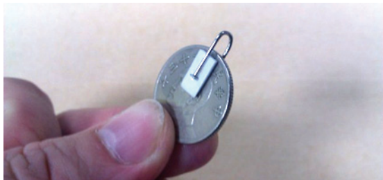
圖(11b) 將 U 字型大頭針兩端均黏於雙面膠上，再用透明膠帶圍繞黏貼於其上，以免大頭針脫落。
