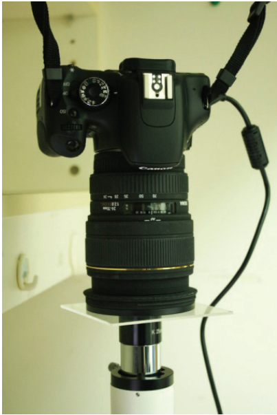
圖二：在目鏡上加入一塊壓克力板
