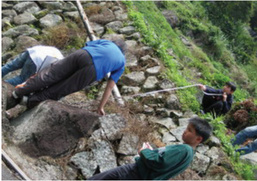
圖 17：量測水耕梯田的護堤高度
