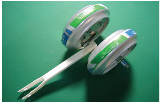
圖三、資料夾塑膠條製成的曲柄和鋁罐製成前輪曲軸組。
