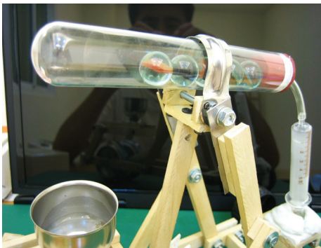
圖五、試管固定鐵環片轉軸兩端分別鎖上螺帽，插銷下方裝入一支白楊木製成的驅動桿。
