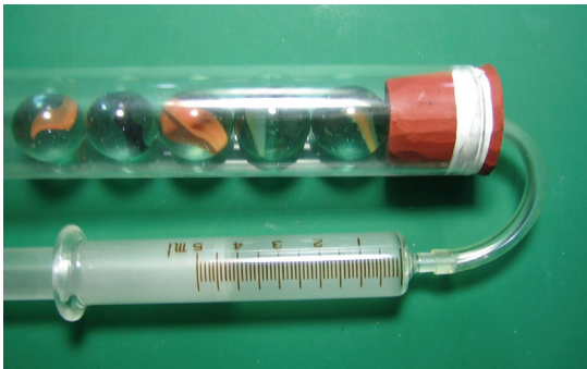
圖二、有彈珠的試管與玻璃針筒組合成史特林引擎主體。
