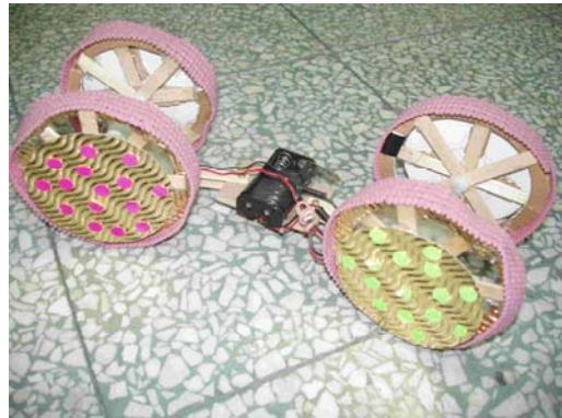
圖七：學生再計畫再製作之車輪版螞蟻雄兵，利用瓦楞紙製作車輪，並在外圍套上止滑墊，更加增強抓地力與穩定性效果，為速度最快且繞圈數最多的冠軍螞蟻雄兵。
