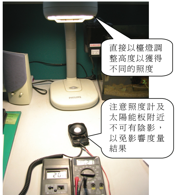
圖 5、調整檯燈高度以測量不同照度的結果
