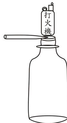
圖三、(B) 用打火機或其他硬體壓扁管口
