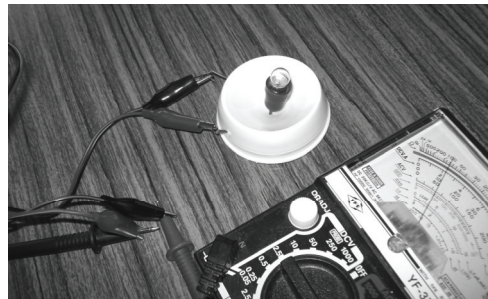
圖六、無刷馬達電流要用 ACV 來檢測
