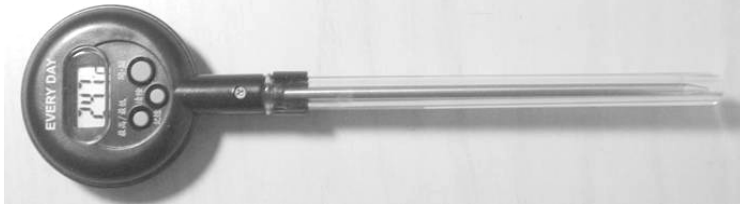
照片 IV-5.溫度計：顯示攝氏溫度值，若顯示華氏溫度值，請監試助理更改。僅讀其顯示的數值，不要碰觸。
