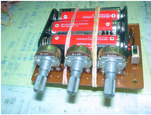
圖三 以橡皮筋將電池盒固定在電路板上
