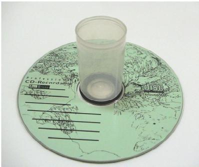
圖一 底片空盒子固定在光碟片上作為「電解槽」
