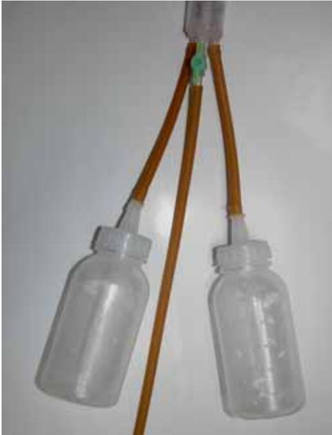
相片二 兩支注射針頭下方各接一條橡皮管及塑膠軟管深入至與塑膠瓶之瓶底接觸
