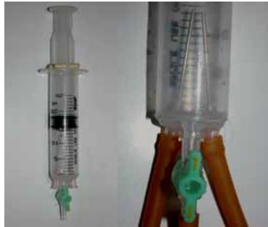
相片一 注射針的金屬部分全部插入注射筒中，注射針的下方接橡皮管
