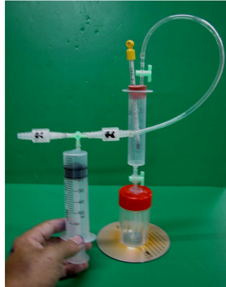
相片一 在注射筒中沸騰的實驗裝置
