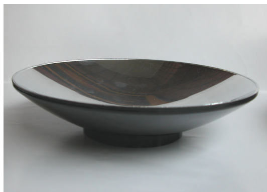
圖B 立體飄浮魔鏡之底座(下面的凹面鏡之內徑 22.0 cm，外徑 22.4 cm)
