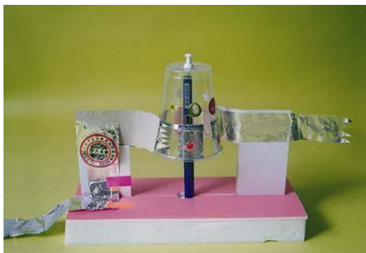
圖四 水晶杯製成的富蘭克林馬達之實物攝影。
