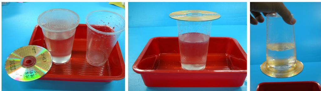
相片六 光碟片中央處無細紗網，但塑膠杯口有紗網
