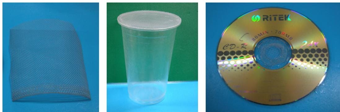
相片三 將細紗網（左）黏在塑膠杯口（中）及光碟片中央（右）
