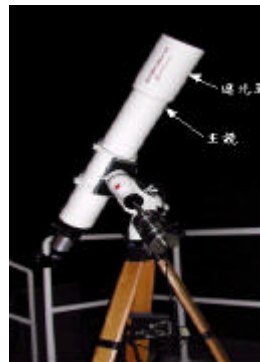
六吋 f/8 APO 折射望遠鏡，以螢石三重透鏡為主鏡。
