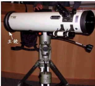
五吋 f/5.5 牛頓式 反射望遠鏡
