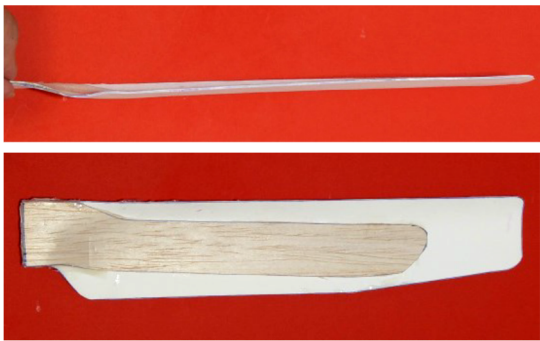
圖九、混合使用甲乙兩種辦法製成的葉片。兩層水彩紙再加上一層巴沙木片。上圖可見葉片具有專業風車特有的曲面與翼形。下圖可見水彩紙和巴沙木薄片結合在一起。
