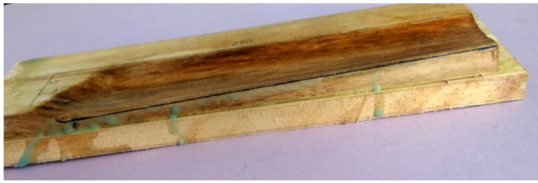
圖二、用桐木製成的模子。為了避免膠沾到模子上造成困擾，所以要將蠟滲入整個木模中
