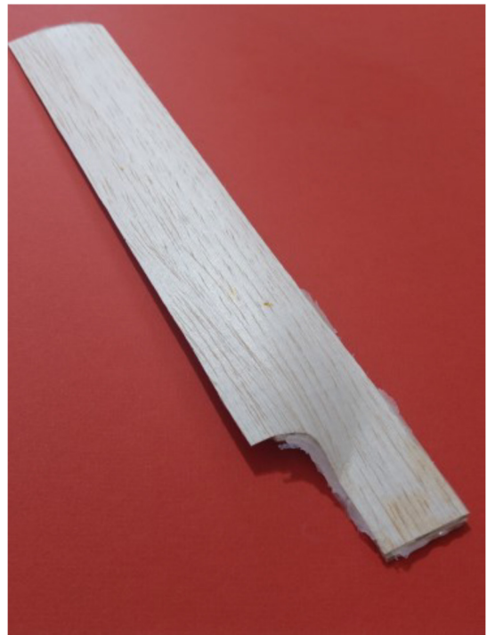
圖六、等待所有的 AB 膠都硬化之後，大約要花半小時到一小時，就可以取出一些形成專業風車葉片形狀的巴沙木薄片，也就完成了葉片的製作。圖中所示為成形的風車葉片之正反面。
