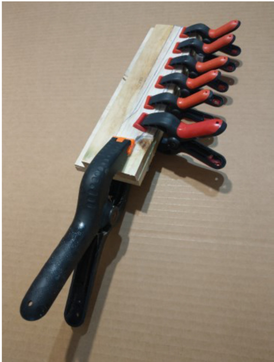
圖五、將巴沙木薄片塗上 AB 膠，黏合起來，先夾在用蠟滲透過的桐木膜子中，待兩片巴沙木薄片之間的 AB 膠硬化後，再加上第三片巴沙木薄片，也用 AB 膠黏合起來。同時用夾具將葉片每一部分與模子夾緊，葉片的形狀就會是模子的形狀，形成專業風車的葉片。
