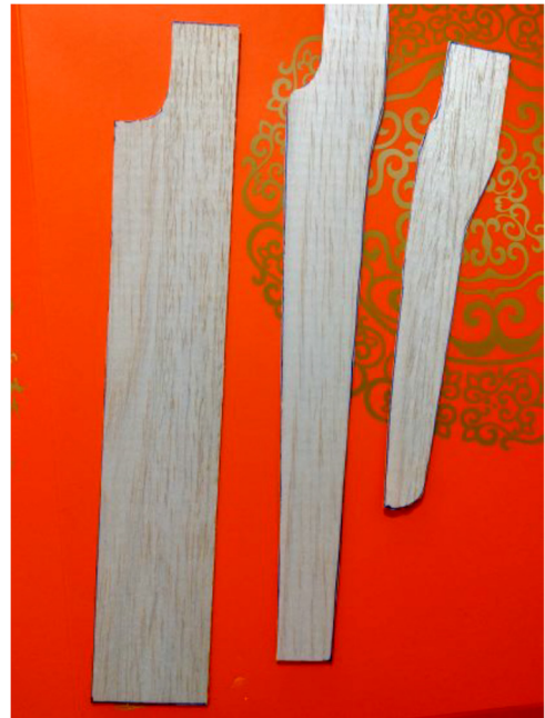
圖四、用尺規畫出一片葉片所需的一組巴沙木薄片(三片)。因為要製作兩個葉片，所以用尺規畫出兩組圖中所示的巴沙木薄片，並且切割下來。
