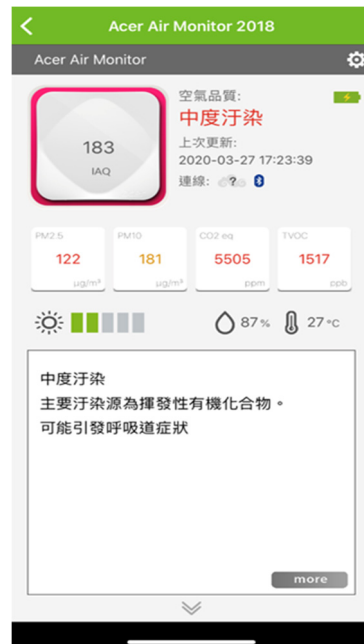
圖 12、培養瓶中燃燒白紙的空氣品質檢測數據
