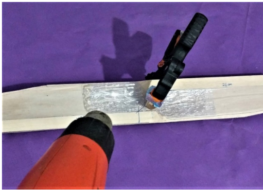
圖十一：較長時間均勻加熱整片 PVC 葉片。
