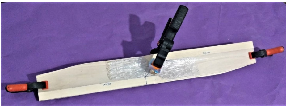
圖十:韌部加強片和 PVC 葉片已黏在一起。先把葉片兩端夾在模具上對應的位置，再用強力夾具夾住雙葉風車的中心。
