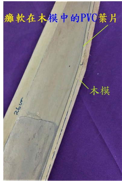
圖十二：靠重力即可使 PVC 葉片貼合模具，只有雙層 PVC 片夾熱熔膠的轂部之若干區域須輕輕施壓
