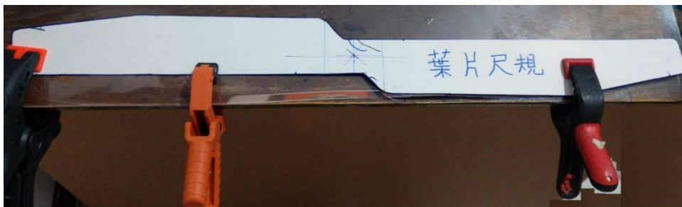
圖七:將 PVC 片、尺規都夾在平木板上,然後用尺規在 PVC 片上畫出葉片形狀。
