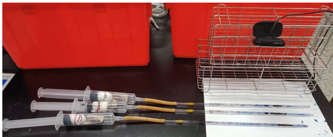
圖四：呼吸週期與代謝率的測量裝置。上圖為裝置示意圖，下圖為實際照片
