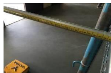
6.發射架側邊固定量尺
