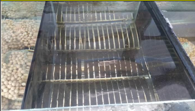
說明：利用報廢日光燈燈罩製作底部過濾浪板
