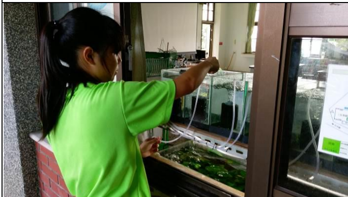
說明：調整打氣風管排氣量
