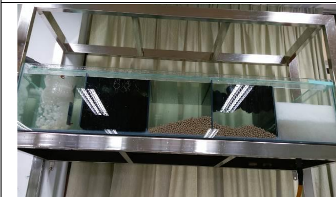
說明：最上層生化過濾缸
