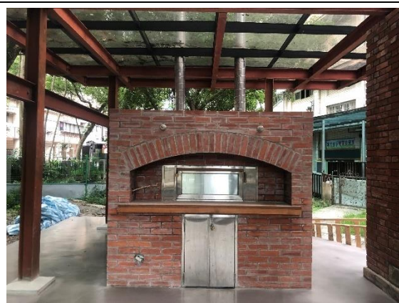
白窯爐口封閉在下方燃燒溫度較一致
