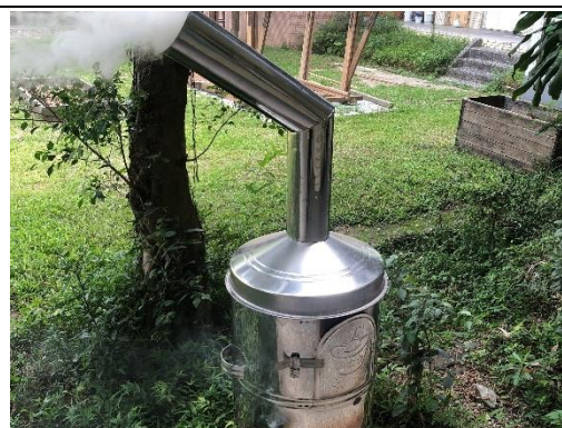
直接燃燒可以使用煙囪冒煙量也較小
