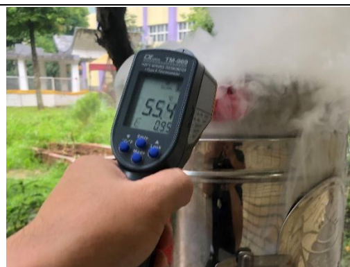
小金爐內溫度 55.4 度，煙燻可以製炭不足
