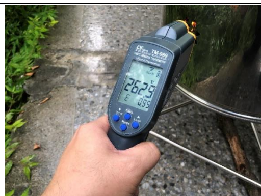
大小金爐套疊燃燒溫度 262.9 度
