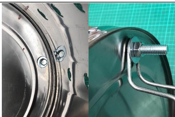
將爐架放在外側，並重新以螺絲鎖住
