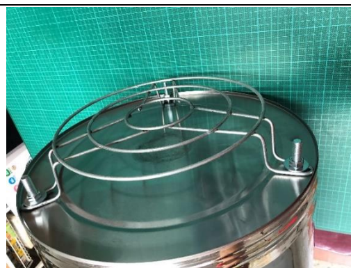
爐架在外側套疊到大金爐通風柱穩定桶身
